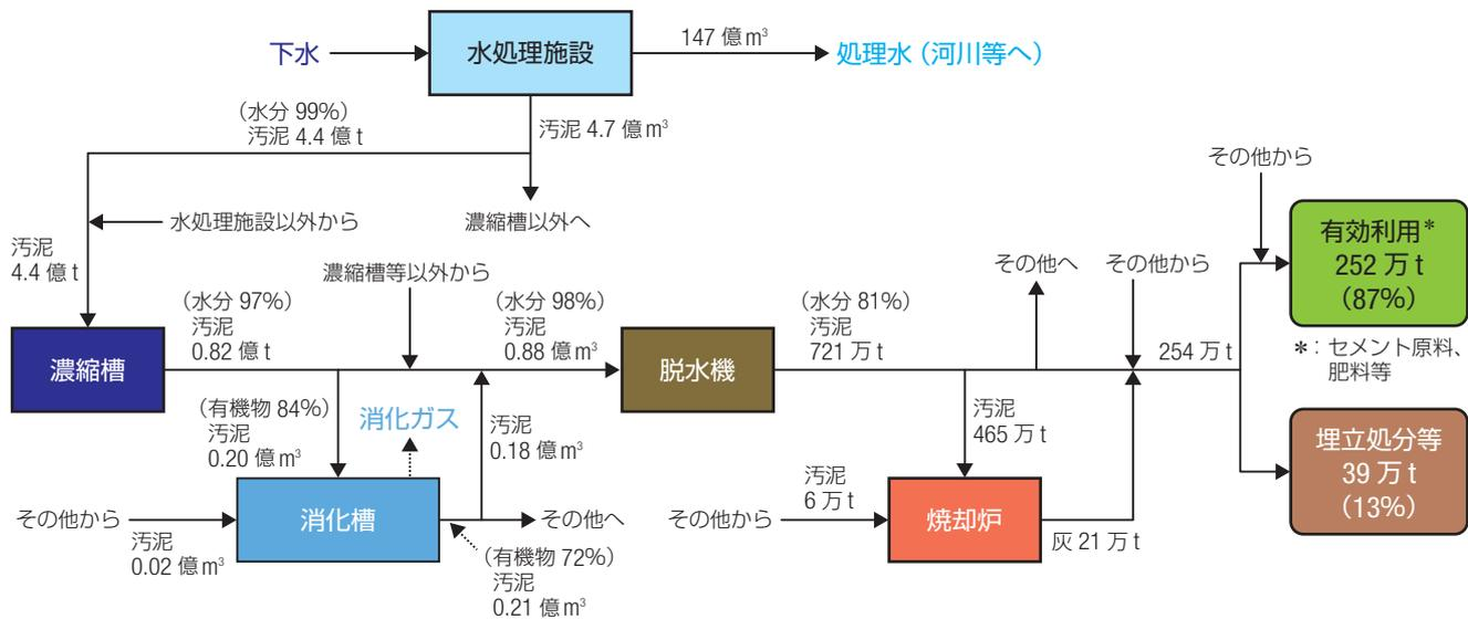
注) 本図は、下水道処理の実フローを簡略化したフロー図。
