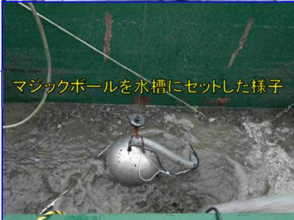
浚渫装置(マジックボール)
